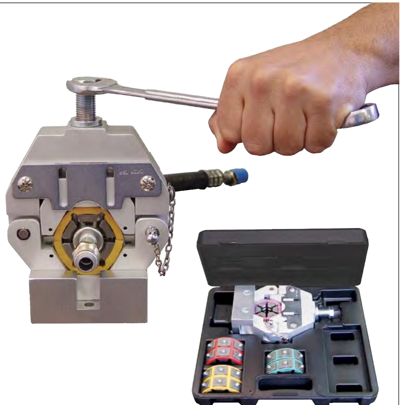
El dado encaja en la instalación de la prensa rápidamente, sin necesidad de clavos o tornillos.
